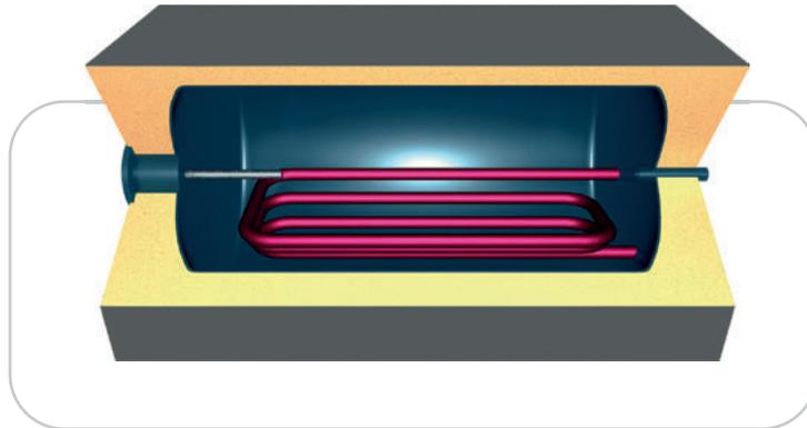
**Anwendung:** Unterstellbrauchwasserspeicher für Öl, Gas, Feststoffe und dergleichen
